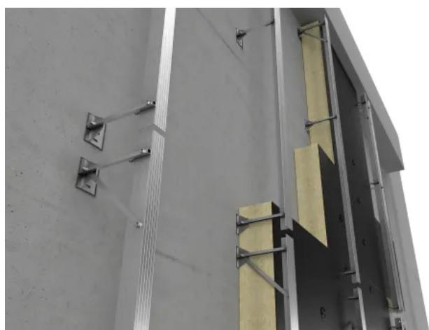
Die Fassadenkonsole TEKOFIX-A++ bietet höchsten Brandschutz, sehr niedrigen Wärmebrückeneinfluss und eine einfache Montage. Durch den punktuellen Aufbau aus Edelstahl setzt die Thermokonsole hohe Maßstäbe im Bereich der Wärmebrücken und erreicht damit Passivhausniveau. Nicht brennbare Bestandteile wie Aluminium und Stahl führen zu hoher Brandbeständigkeit. So kann die Konsole auch in Hochhäusern eingesetzt werden.
