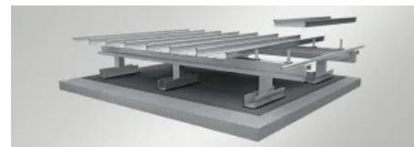
Statische Prüfungen und bauphysikalische Analysen stehen am Anfang einer Dachsanierung mit Metallprofilen. In trittfesten Bereichen kann BEMO-ELEVATE direkt auf die vorhandene Dachfläche aufgebracht werden. Weiche Bereiche oder Bereiche mit unklarer Tragstruktur werden geöffnet und die ELEVATE-Profile direkt auf der tragenden Ebene verschraubt.
