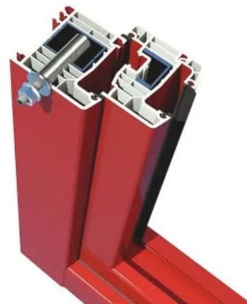
Der Gewindeanker trägt die Lasten der Absturzsicherung direkt in die Fensterbewehrung ab.
