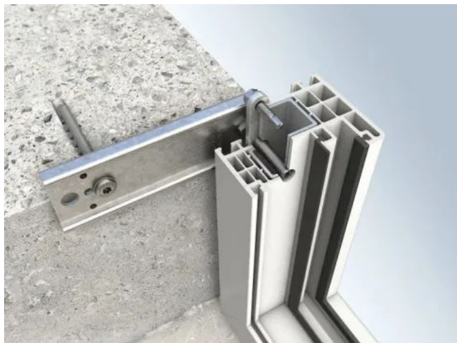
Absturzsichernde Befestigung eines Kunststofffensters an einer Beton-Laibung mit Würth Fenstermontagesystem W-ABZ 2
