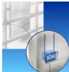
Die Peikko® PSK - Wandschuhe sind Einbauteile zur Herstellung von zugfesten Verbindungen von Fertigteilwänden. Als zugehörige Ankerbolzen dienen Peikko® HPM - Ankerbolzen mit spezieller AL- Unterlegscheibe.
