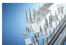
Die PEIKKO- Ankerplatten ermöglichen dem Anwender Bauteile aus Stahl, Stahlbeton oder Holz etc. mit einem Stahlbetonbauteil zu verbinden. Die Bauteile werden vorwiegend über Schweißnähte miteinander verbunden, sodass man auch von Anschweißplatten sprechen kann. Alternativ können PEIKKO Ankerplatten mit Gewindemuffen geliefert werden, die das Schweißen an der Baustelle umgehen und die Verbindung der Bauteile durch eine Verschraubung ermöglichen.
