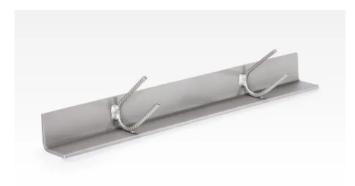
Kantenschutzwinkel JKW sichern Ecken von Stützen und Wänden in Parkhäusern und Hochregallagern vor Beschädigungen. Sie werden verlegefertig mit Ankern geliefert und einbetoniert. Die U-förmig gebogenen Rundstahlanker lassen sich leicht in den Bewehrungskorb einpassen und stellen keine Behinderung für die Eckbewehrung dar. Durch ihre Abkantung in einem Winkel von 92° sind eine gute Anlage an der Schalung sowie ein sauberer Betonabschluss gewährleistet.
