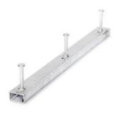
Ob im Tunnelbau, im Kranbau oder in Versorgungskanälen, mit den Zahnschienen JZA werden Anschlusselemente stets sicher befestigt. Die kaltgeformten, gezahnten Ankerschienen stellen mit den zugehörigen Zahnschrauben formschlüssige Verbindungen ohne Verrutschen sicher. Die Zahnschienen sind in der Lage, Lasten in alle Richtungen aufzunehmen und erlauben so, flexibel auf sich ändernde Anforderungen der Umgebung zu reagieren.
