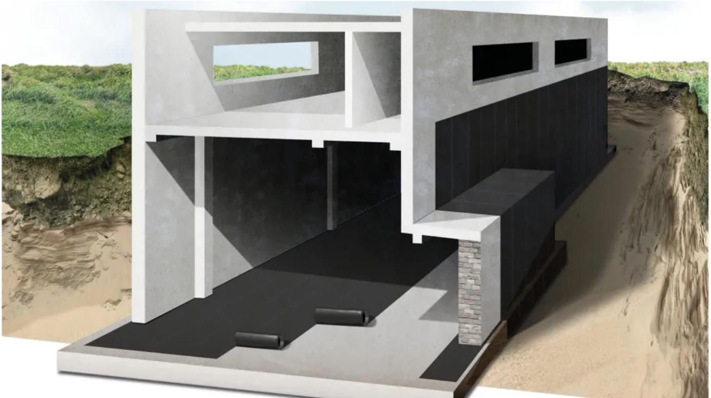
Einbausituation für die Abdichtung von erdberührten Bauteilen nach DIN 18533
