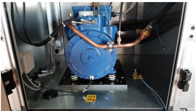
Lagerung eines Kompressor mit Isotop DMSN
