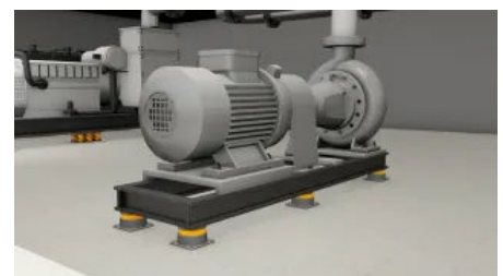
3D-Modell: Pumpenlager ohne zusätzliche Masse
