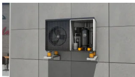
3D-Modell: Lagerung einer Kompressoreinheit
