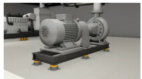
3D-Modell: Pumpenlager ohne zusätzliche Masse
