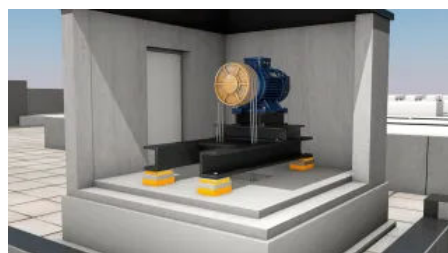
3D-Modell: Doppelte elastische Lagerung Aufzug
