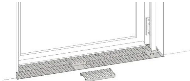
Der 6-teilige Rost kann zur Revision einfach entnommen werden, zuerst die mittleren Teile, dann die Seitenteile.
