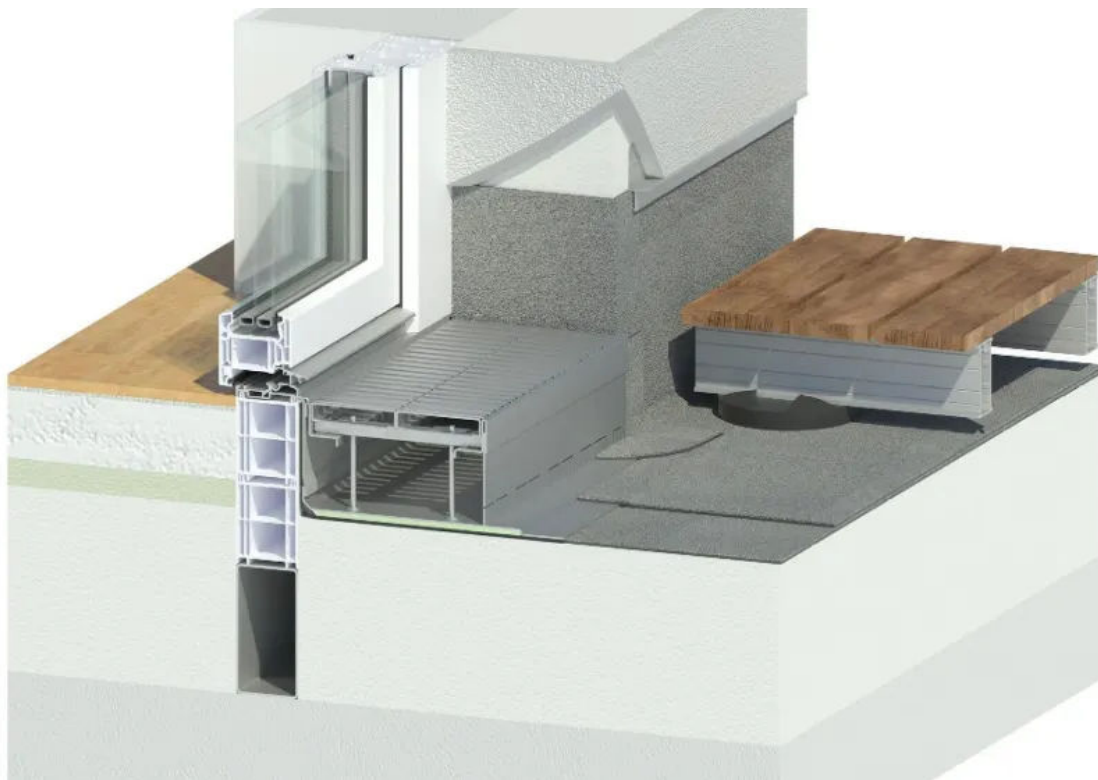
Barrierefreie Fassadenrinne INNORIN® F für den wärmebrückenfreien Anschluss an begehbaren Flachdächern
