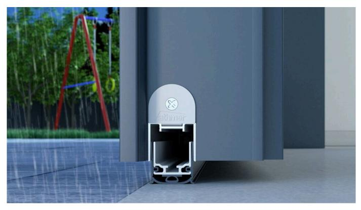
Barrierefreie Außentürdichtung mit nachweislicher Dichtigkeit gegen Schlagregen, Windlast und Lärm - trotz Nullschwelle. Die barrierefreie Außentürdichtung Athmer Rainstop® ist schlagregendicht und erfüllt - wie alle Athmer Stadi-Dichtungen - die Anforderungen an Schallschutz, Rauchschutz und Brandschutz, erzielt Schalldämmwerte bis 54 dB und ist für Holztüren wie auch Systemtüren aus Alu, PVC oder Stahl verfügbar.
