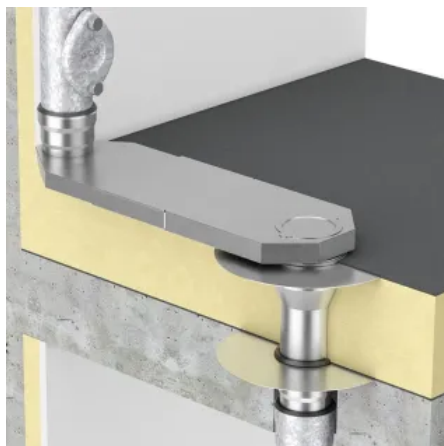
Flachkanal, Anschluss an Balkonablauf mit Klebeflansch | © ACO Haustechnik
