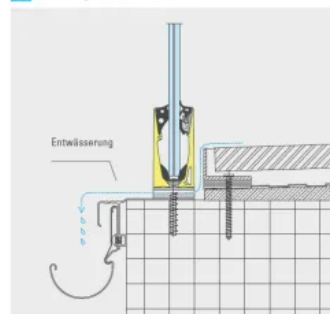
3 Anbindung von oben an Balkon
