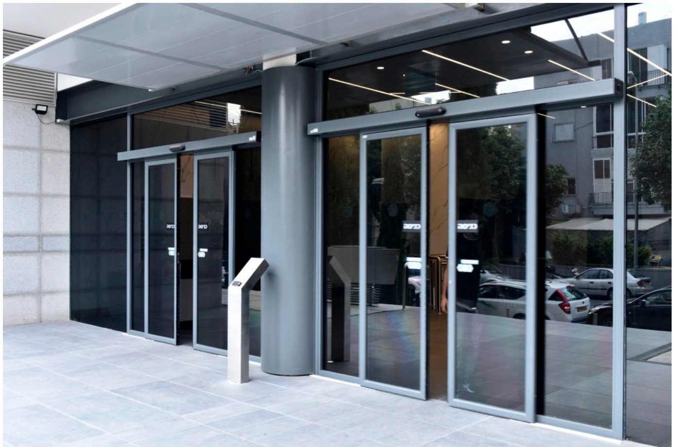
Total-Öffnungssysteme: Besonders für den Einsatz in Flucht- und Rettungswegen geeignet
