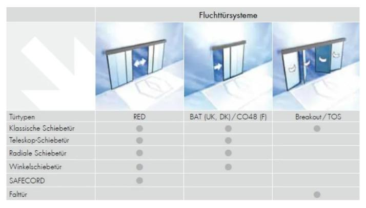
Die redundante Ausführung (RED) besteht aus zweifach ausgeführte Antriebsmotoren, zwei voneinander unabhängigen Steuerungen und einem Akku zur Durchführung einer Notbewegung bei Stromausfall.
