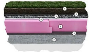
Austrotherm Gründach Aufbau
