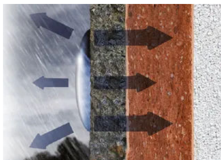
Mineralische Putzoberfläche. Überschüssige Feuchtigkeit wird vorübergehend in die Kapillaren aufgenommen.
