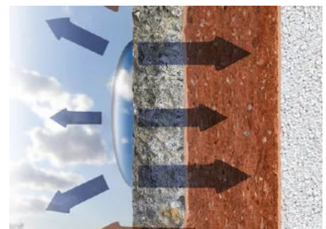
Bei POROTON®-WDF® kommt den Eigenschaften des Dickputzes der 15 mm dicke Ziegelsteg zugute. Die Trocknung der Fassadenoberfläche wird durch gute Wärmespeicherung begünstigt.
