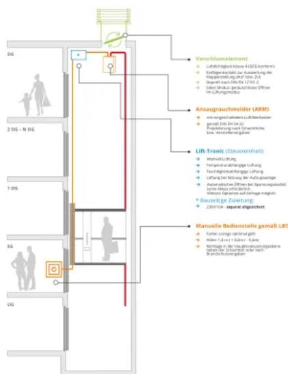
Das System mit Ansaugrauchmelder überwacht den gesamten Aufzugsschacht über ein Rohrsystem, in dem in regelmäßigen Abständen Ansaugbohrungen eingebracht werden. Angesaugter Rauch wird an einer zentralen Stelle erkannt und für zum Öffnen der Verschlussklappe. Der Brandrauch kann dadurch schnell und ungehindert entweichen.
