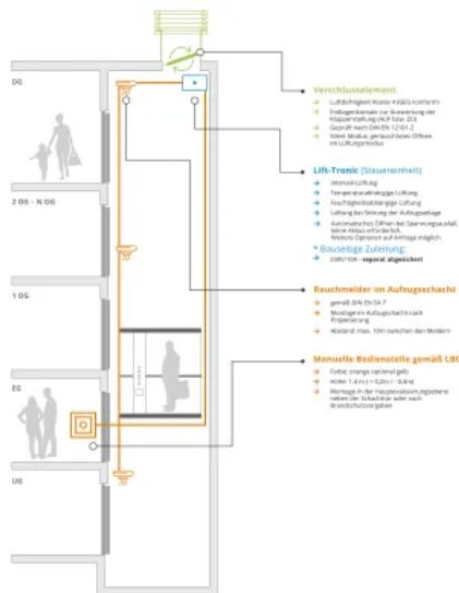
Beim Rauchmeldersystem (RMS) werden zur Detektion einzelne Rauchmelder in einem Abstand von 10 Metern Schachthöhe im Aufzugsschacht montiert.
