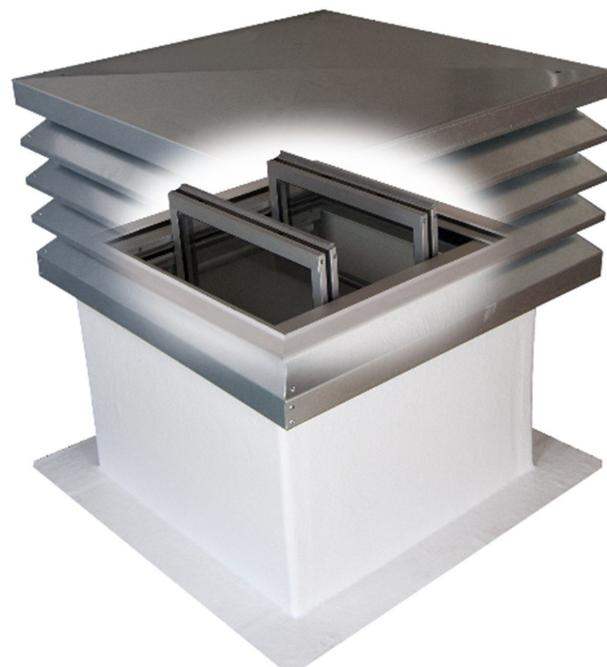
Das wirtschaftliche Aufzugsschachtentrauchungs-System LiSE® arbeitet mit einer geschlossenen Rauchabzugsöffnung, die mittels Detektion durch automatische oder manuelle Melder geöffnet wird. Die Öffnung wird nur im Bedarfsfall zur kontrollierten Lüftung oder für den Rauchabzug geöffnet. So werden unnötige Wärmeverluste vermieden. Außerdem ist die Eigenstromaufnahme dieses Systems gering, da keine permanente Luftansaugung erfolgt.
