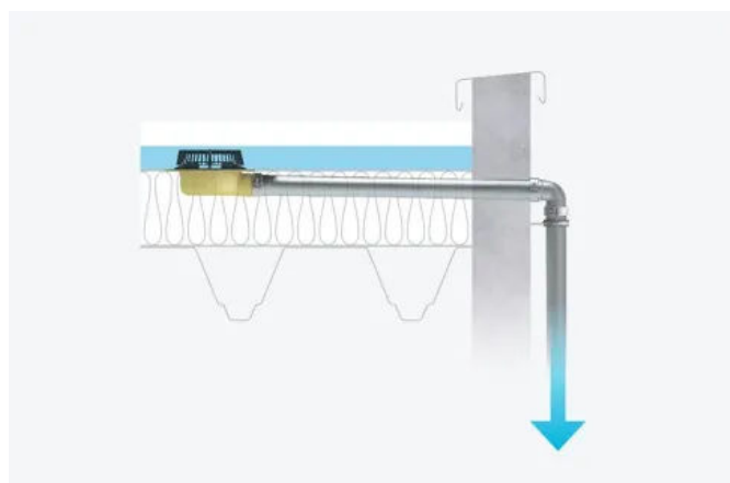
C: Innerhalb der Dämmung: SitaDSS Indra
