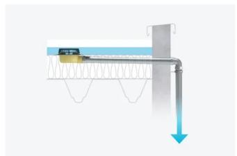
C: Innerhalb der Dämmung: SitaDSS Indra
