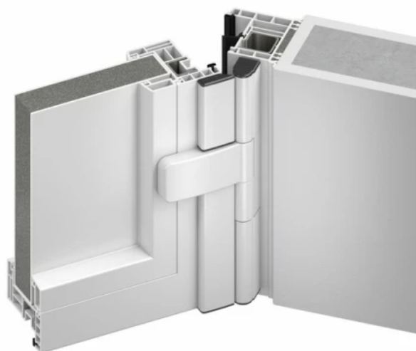
Das Schutzprofil BA-22+ ist stufenlos einstellbar für Drehpunkte von 22-38 mm.
