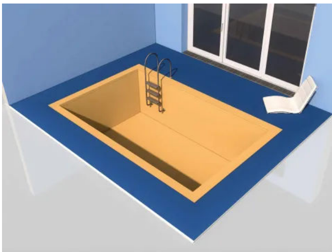
DIN 18535 – Abdichtung von Behältern und Becken
