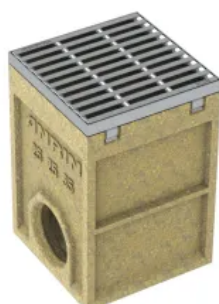
SELF Hofeinfahrt mit verzinktem Stahlrahmen und einliegendem verzinktem Maschenrost, MW 33 x 12 mm
