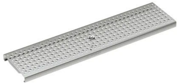
Lochrost, Stahl verzinkt, Edelstahl Belastungsklassen: A15, C250, Länge: 50 cm, 100 cm, Ø 6 mm
