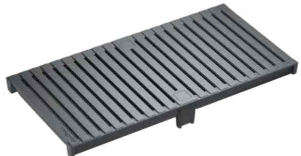
Stegrost, HEELGUARD, Guss GJS, schwarz lackiert Belastungsklassen: D400* Länge: 50 cm, SW 6 mm
