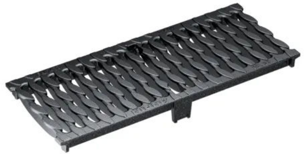
Guss-Stegrost mit OvalGrip Design, Guss GJS, KTL beschichtet Belastungsklassen: D400*, E600* Länge: 50 cm, SW 12 mm
