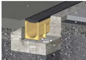
SF-200 mit Fahrbahnbeton bzw. Betonplatten oder Pflasterdeckung
