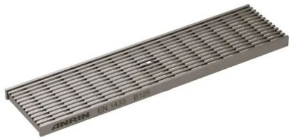
Längsprofilrost, Edelstahl Belastungsklassen: B125, D400, Länge: 50 cm, 100 cm, SW 5 mm
