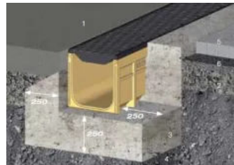
SF-300 mit Fahrbahnbeton bzw. Betonplatten oder Pflasterdeckung
