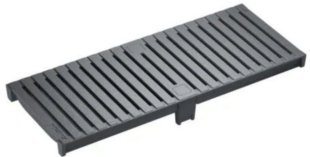
Stegrost, HEELGUARD, Guss GJS, schwarz lackiert Belastungsklasse: D400* Länge: 50 cm, SW 6 mm
