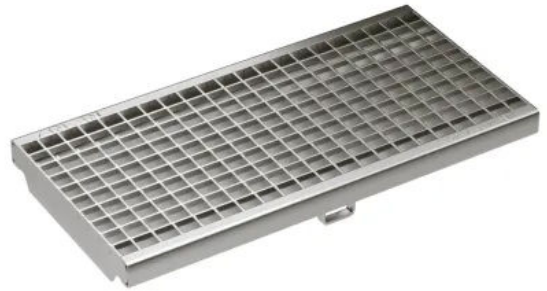
Maschenrost, Stahl verzinkt, Edelstahl Belastungsklassen: D400* Länge: 50 cm, 100 cm, MW 20 x 20 mm
