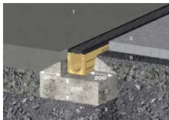
SF-100 mit Fahrbahnbeton bzw. Betonplatten oder Pflasterdeckung
