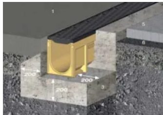
SF-200 mit Fahrbahnbeton bzw. Betonplatten oder Pflasterdeckung
