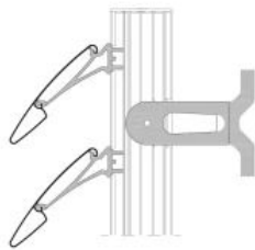
WICSOLAIRE - Lamellen mit Tragkonstruktion (©WICONA)
