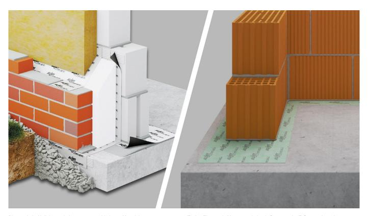
Bitumenfreie Abdichtungsbahnen aus verschiedenen Materialzusammensetzungen für den Einsatz als Mauersperrbahn, L-Sperren oder Z-Sperren in und unter Wänden.
