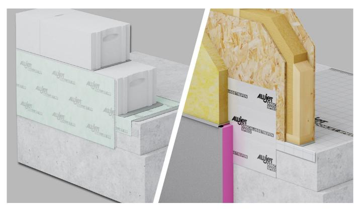
Abdichtungssysteme für die Sockelabdichtung.
