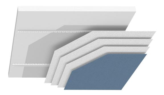
Die Akustikputze sind für bauliche Gegebenheiten geeignet, in denen keine ab- oder vorgehängten Akustiksysteme möglich sind.
