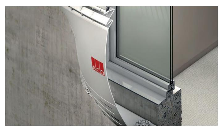
ACO Therm® Lichtschachtsysteme sorgen für einen größtmöglichen Lichteinfall sowie Luftaustausch in den Kellerräumen. Die Kellerlichtschächte sind formstabil und besitzen eine lange Lebensdauer. Aufstockelemente ermöglichen einen Höhenausgleich.
