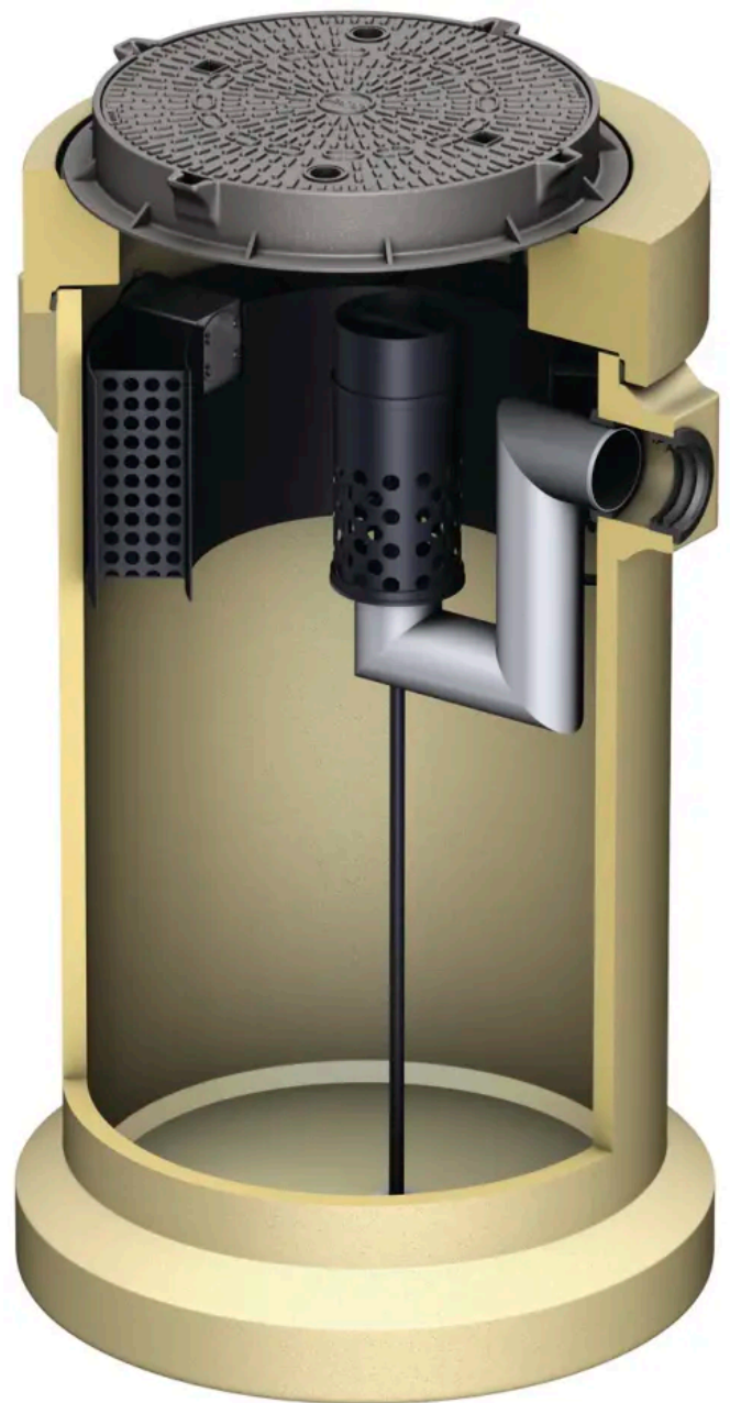
Mit filterloser Koaleszenzeinheit (Polymerbeton) Oleosmart Pro
