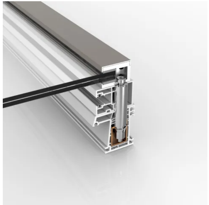
Glasabsturzsicherung VITRUM Classic mit Abstandhülse in Kombination mit Rollladenführungsschiene
