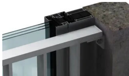
Befestigungsvariante in der Laibung
