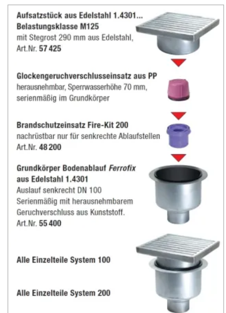
Beispiel für die Kombination im Baukastensystem
