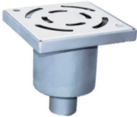
Bodeneinlauf mit Geruchverschluss zum Anschluss an DN 100, DN 70, DN 50
