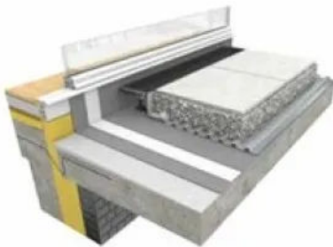
Begehbare Flachdach mit Plattenbelag auf Drainschüttung: Abdichtung mit MB PUReactive TX und Vlieseinlage oder MB PUReactive+ ohne Vlies.
