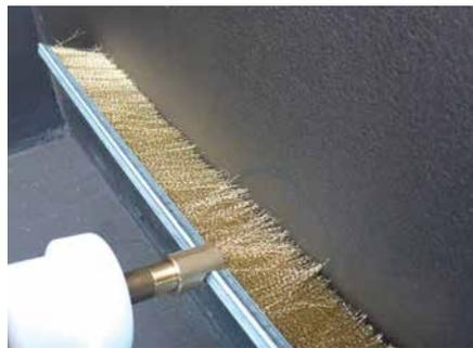
Auf Poren, Löcher, Risse oder Fehlstellen wird mittels einer Funkenentladung und einem akustischem Signalton hingewiesen.
