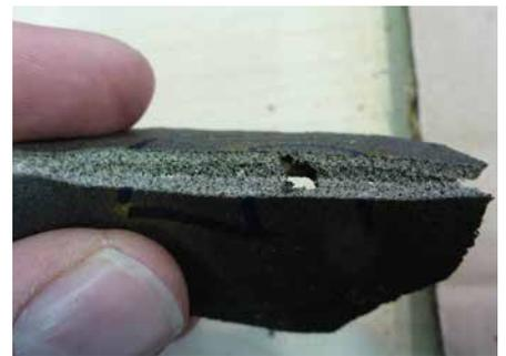
Trotz eines mehrschichtigen Auftrags der Abdichtung können kleine Fehlstellen und Schwankungen der Schichtdicke auftreten, die durch bloße Betrachtung häufig schwer zu erkennen sind.
