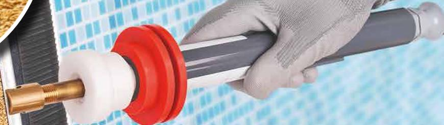
Schnelle, effiziente und zerstörungsfreie Fehlstellenprüfung der Verbundabdichtung (AIV)
