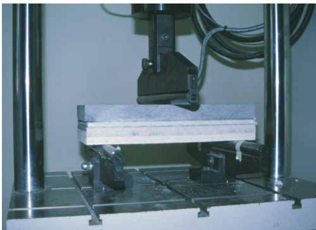
Versuchsordnung zur Prüfung der Durchbiegung und maximalen Lastaufnahme eines entkoppelten Systems.
