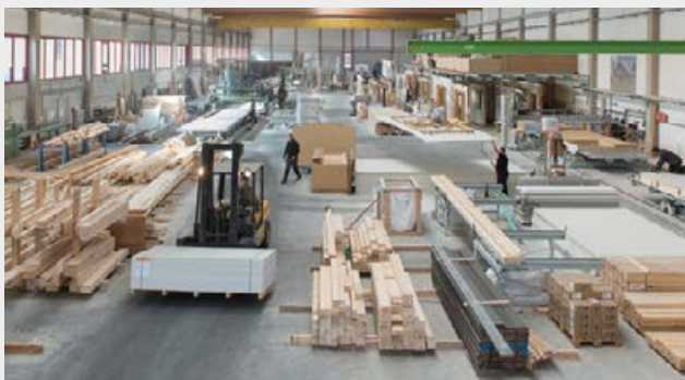
Fertigung von Holzbauelementen mit fermacell® Gipsfaserplatten
