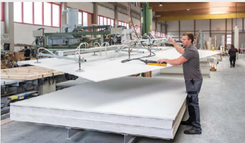
Transport von fermacell® Gipsfaserplatten mit einem Vakuum-Hebegerät
