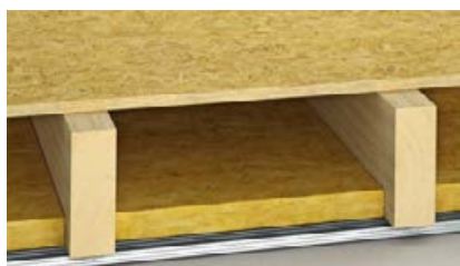
Trockenestrich-Aufbauten zum Erreichen L'_{n,w} = 50 dB
