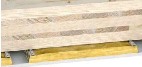
Massivholzdecke in Verbindung mit einer Unterdecke
