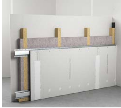
fermacell™ Holzständerwand • F30-B (mit Federschiene) • Dämmstoff: B2
