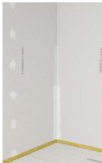
fermacell® Vapor - Inneneckausbildung: Ausführung mit einem Kompositteckband mit dampfbremsender Wirkung (Protektor WetFlex, MidFlex IS-300, MidFlex OS-300 oder gleichwertig)
