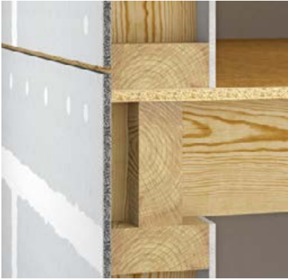
Bild 3: Mit HD-Fugentechnik versehener Bereich des Plattenstreifens
