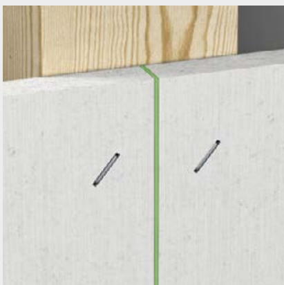
Klebefuge -Fugenbreite ≤ 1 mm
