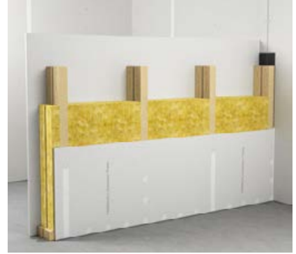
1 HT 11-212 fermacell™ Holzständerwand • F30-B • Doppelständerwand
