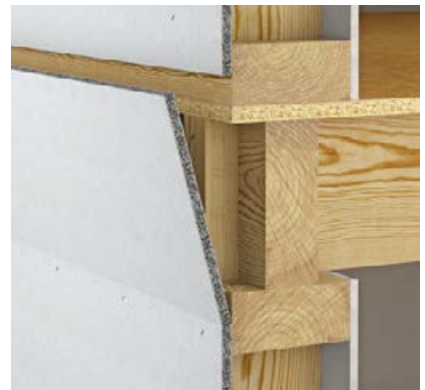
Bild 2: Montage des Plattenstreifens
