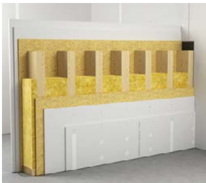
4 HT 21-400 fermacell™ Brandwand • F60-B (REI60-M) • Holzwerkstoff
