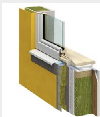
10 HA 25-400 fermacell™ Außenwand (GK4) - Fenstereinbau (objektbezogene Detaillösung)
