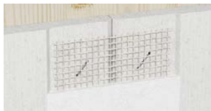
Trockenbaukante, Plattenstoß dicht gestoßen
