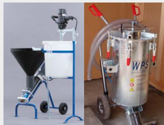
Mörtelpumpen zur Untermörtelung der Schwelle
