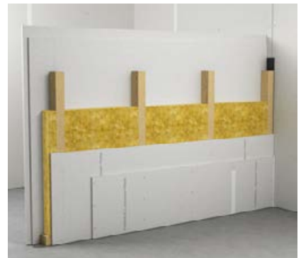
1 HT 21-211 fermacell™ Holzständerwand • F60-B • Doppelständerwand
