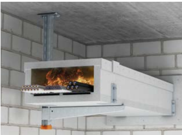
Aestuver™ Kabelkanal-Systeme "Exklusiv" (I-Kanäle) I 30 bis I 90 nach DIN 4102, Teil 11 für die Kapselung der Brandlast in Flucht- und Rettungswegen
