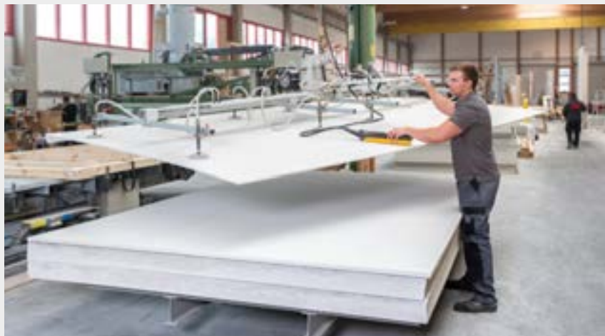
Transport von fermacell® Gipsfaserplatten mit einem Vakuum-Hebegerät
