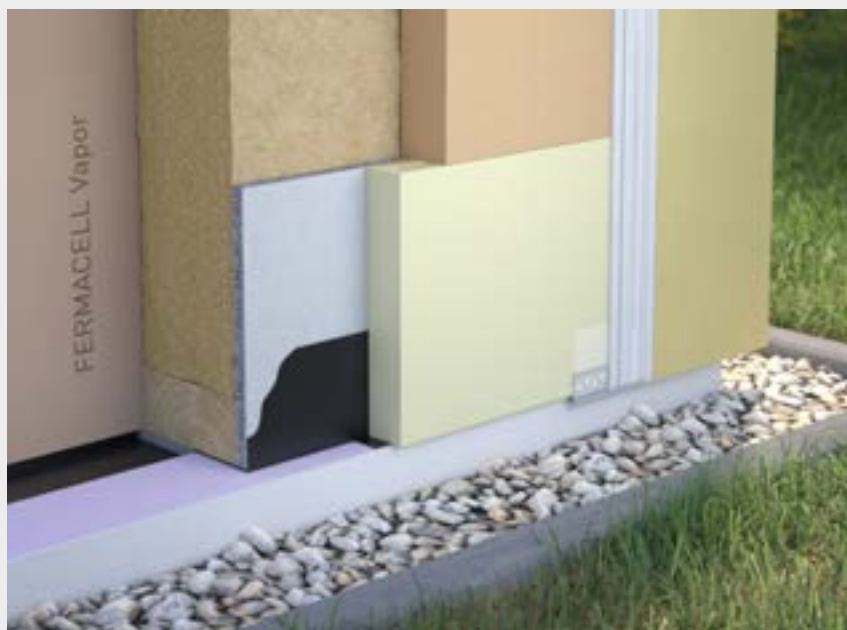
1 HA 16-032 fermacell™ Außenwand - Abstand Unterkante Holz/Oberkante Gelände: \geq 5 cm
