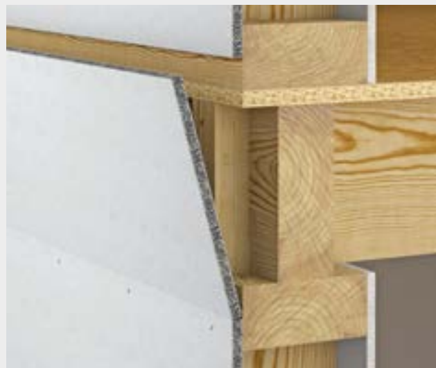
Bild 2: Montage des Plattenstreifens
