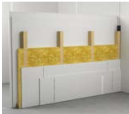
1 HT 21-211 fermacell™ Holzständerwand ■ REI60 / F60-B ■ Doppelständerwand
