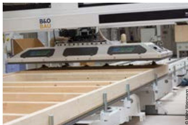
B&O Bau GmbH - Portaleinblasplatte (Dämmstoff gem. MHolzBauRL)
