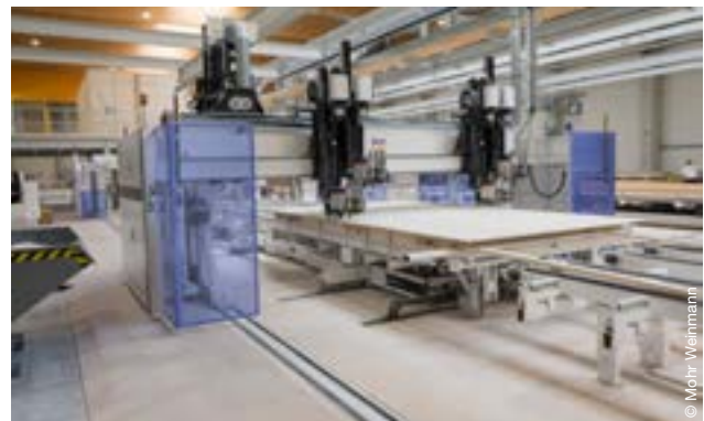
B&O Bau GmbH - Klammerbrücke (Plattenbefestigung)
