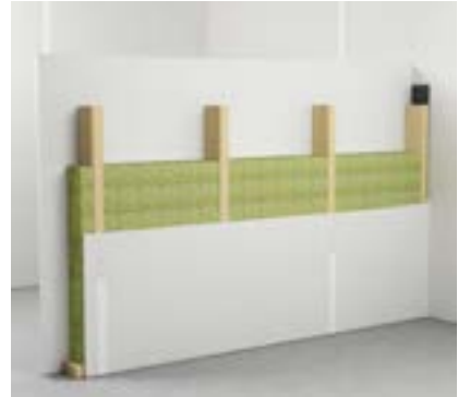
1 HT 21-300 fermacell™ Holzständerwand ■ REI60 / F60-B ■ Mineralwolle
