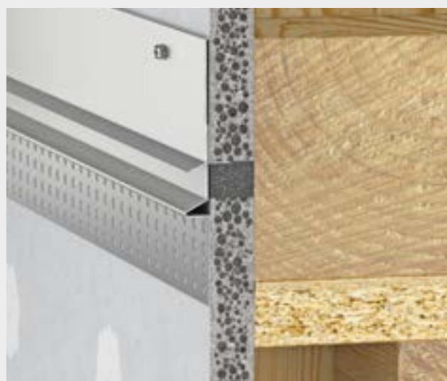
Bild 4: Befestigung des Profils (Detail)
