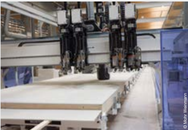
B&O Bau GmbH - Zuschnitt (Türöffnung)
