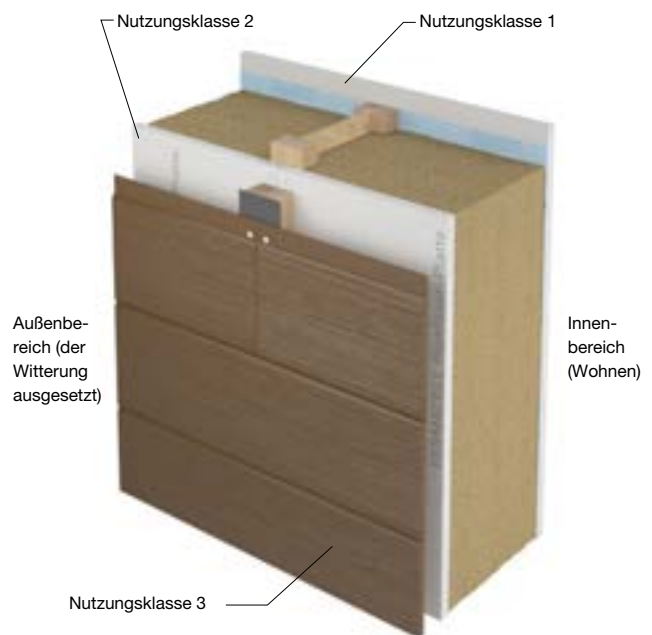
Definition der Nutzungsklassen gem. DIN EN 1995-1-1 Bsp.: 1 HA 21-430 fermacell™ Außenwand (REI60 / F60-B)
