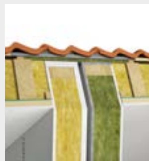
Abb. 6: Wandelementstoß – Vertikalfuge (Detaildarstellung)
