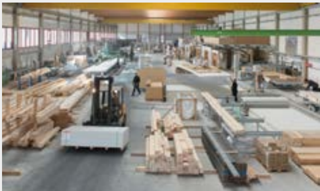
Fertigung von Holzbauelementen mit fermacell® Gipsfaserplatten
