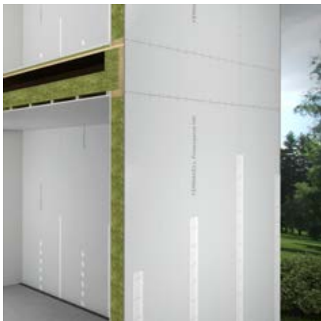
1 HG 32-500 fermacell™ Powerpanel HD Gebäudeabschlusswand (F90-B außen /F30-B innen ) - temporärer Wetterschutz bei einer Reihenhausbauung/erste Gebäudehälfte
