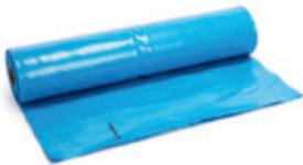
Polyethylenfolie mit  $s_d > 160$  m. In lose verlegten bzw. mechanisch befestigten Schichtenaufbauten mit Rhepanol-Dachbahnen bei nicht klimatisierten Aufenthaltsräumen nach DIN 4108, Teil 3. Brandklasse B2 bzw. Klasse E.
