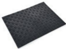
Zur Gestaltung von Wartungswegen auf Rhepanol hfk. Rutschhemmende und lastverteilende Wirkung. Einfache Fixierung mit FDT Klebe- und Dichtungsmasse oder Heissluftverschweißung. Gesamtdicke 9 mm, davon 4 mm Noppenhöhe.
