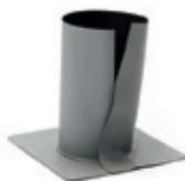
Fertigteil-Manschetten für den wasserdichten Anschluss der Dachbahnen an runde Durchdringungen (z. B. Geländer, Rohre, Absturzsicherungen etc.). Sie wird um die Durchdringung herumgeführt und dann im aufgehenden Bereich verschweißt. Anschließend die Manschette (Höhe ca. 28 cm) mit der Dachbahn verschweißen. Andere Größen ab einer Stückzahl von 20 auf Anfrage möglich. Warmschrumpfschlauch in Kombination siehe Seite 31.
