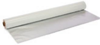
Gewebeverstärkte und selbstklebende Alu-Verbundfolie nach DIN 18234.  $s_d > 1.500$  m (praktisch dampfdicht). Brandklasse B2 bzw. Klasse E.
