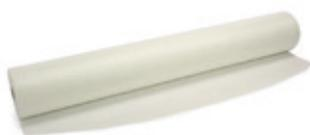
Chemisch gebundenes Glasfaservlies. Als Trennlage gegen Wechselwirkungen zwischen Rhenofol-Dachbahnen und unverträglichen Stoffen, wie z. B. Polystyrol-Hartschaumplatten, und als Brandschutzlage in mechanisch befestigten Schichtenaufbauten mit Rhenofol- und Rhepanol hfk-Dachbahnen.
