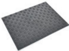
Zur Gestaltung von Wartungswegen auf Rhenofol CV und anderen PVC-Dachbahnen. Rutschhemmende und lastverteilende Wirkung. Einfache Fixierung mit FDT Klebe- und Dichtungsmasse oder Heissluftverschweißung. Gesamtdicke: 9 mm, davon 4 mm Noppenhöhe.
