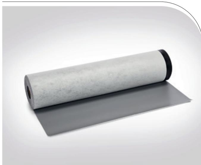
Die Dachbahn Rhepanol hfk-bs besteht aus dem bewährten Rohstoff Polyisobutylen (PIB) mit einer 1,0 mm dicken Kombikaschierung aus Polyestervlies und Glasvlies sowie einem vliesfreiem Rand. Die Dachbahnen werden im Nahtbereich ganz einfach mittels Heißluftverschweißung homogen gefügt.
