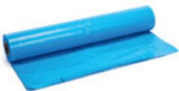
Polyethylenfolie mit  $s_d \geq 100$  m. In lose verlegten bzw. mechanisch befestigten Schichtenaufbauten mit Rhepanol-Dachbahnen und bei nicht klimatisierten Aufenthaltsräumen nach DIN 4108, Teil 3. Entspricht den Anforderungen der DIN 18234-1. Als Trennlage bei Rhepanol CG unter Kies und bei extensiver Begrünung. Brandklasse B2 bzw. Klasse E.
