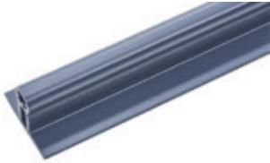
Zur ästhetischen Nachbildung von Stehfalz mit einer Höhe von 25 mm auf Rhenofol CV. Erforderliche Andrückrolle für die Höhe 25 mm siehe Seite 34. Inkl. Rhenofol-Stoßverbinder (1 St./2 m). Die Länge der Stehfalzprofile beträgt 2 m. Weitere FDT-Standardfarben auf Anfrage.
