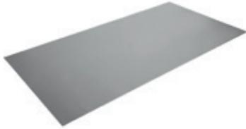
Mit Rhepanol h kaschiertes, feuerverzinktes Stahlblech mit rückseitig grüner Schutzlackierung. Zum Herstellen von Profilen für An- und Abschlüsse. Können wie verzinkte Bleche geschnitten und gekantet werden. Alle Rhepanol-Dachbahnen können mit Rhepanol-Anschlussblech verbunden werden (Blechdicke: 0,6 mm, Beschichtung: 0,6 mm).
