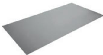
Ein mit Rhenofol C kaschiertes, feuerverzinktes Stahlblech mit rückseitiger schwarzer Schutzlackierung. Zum Herstellen von Profilen für An- und Abschlüsse und Fixierungen. Können wie verzinkte Bleche geschnitten und gekantet werden. Weitere FDT-Standardfarben auf Anfrage (Blehdicke: 0,6 mm, Beschichtung: 0,6 mm). Für den Anschluss von Rhenofol-Dachbahnen.
