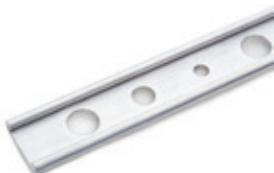
Biegesteifes U-Profil aus Aluminium in gelochten 2-m-Längen. Zur Rand- und Zwischenfixierung an aufgehenden Bauteilen von Rhepanol- und Rhenofol-Dachbahnen.
