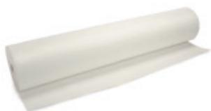
Hochreißfest und thermisch gebunden, bohrfest und alkalibeständig. Als Schutzlage gegen raue Untergründe. Bei Kiesaufbauten mit Rhenofol, Einsatz in Verbindung mit PE-Folie bei nicht normgerechtem Kies. Als Trennlage, um Wechselwirkungen zwischen unverträglichen Materialien zu verhindern, z. B. zwischen Rhenofol-Dachbahnen und Altbitumenflächen.
