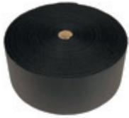
Hochreißfester Polyesterträger mit Pilzkrallen. Für die Befestigung von Rhepanol hfk im Klettsystem. Die Befestigung erfolgt mit handelsüblichen Befestigern und Haltetellern (max. 5 cm breit).
