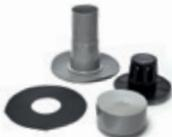
Aus erhöht schlagzähem PVC hart. Lüftungsquerschnitt von 114 cm<sup>2</sup>. Die auf die FDT Dunstrohrhaube aufgesteckte FDT Wetterkappe kann zu Wartungszwecken abgenommen werden. Einbaufertig mit integrierter Manschette. Korpus: grau. Höhe Kondensatschale: 14 cm.
