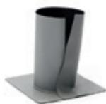
Fertigteil-Manschetten für den wasserdichten Anschluss der Dachbahnen an runde Durchdringungen (z. B. Geländer, Rohre, Absturzsicherungen etc.). Sie wird um die Durchdringung herumgeführt und dann im aufgehenden Bereich verschweißt. Anschließend die Manschette (Höhe ca. 28 cm) mit der Dachbahn verschweißen. Andere Größen ab einer Stückzahl von 20 auf Anfrage möglich. Warmschrumpfschlauch in Kombination siehe Seite 31.
