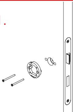
1. Vormontierte Seite und Montageplatte an der Tür verschrauben
