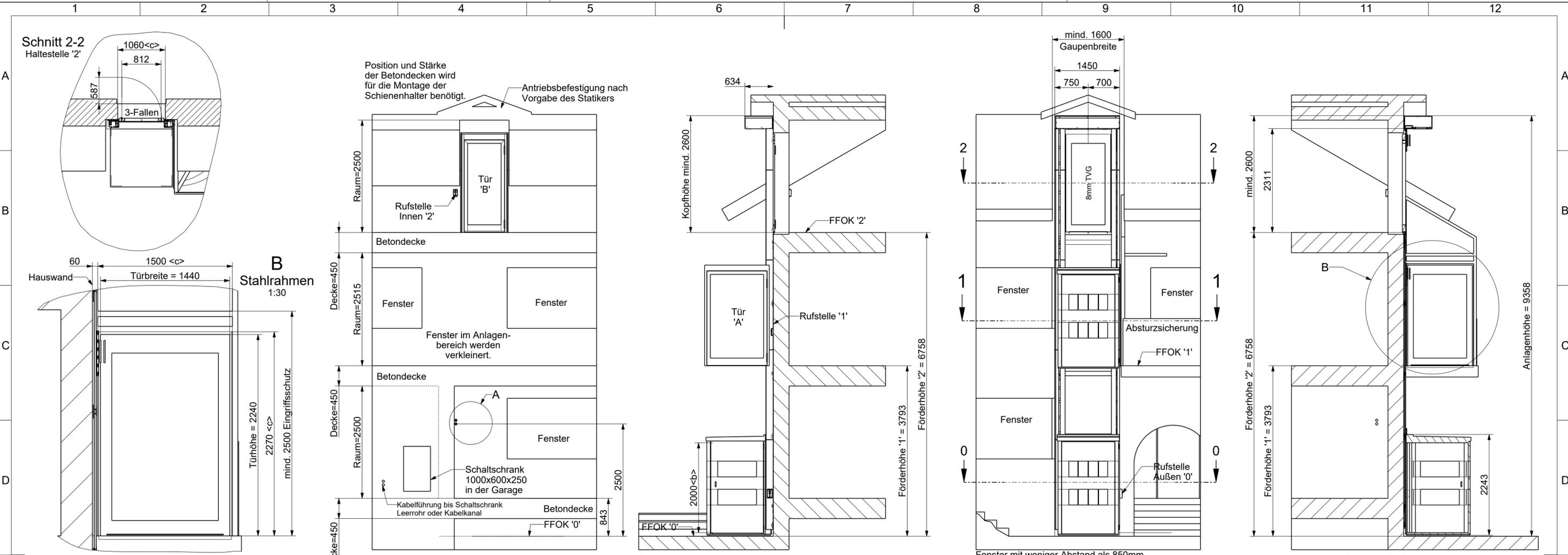
Stahlpodest und Stahlrahmen müssen durch einen Statiker ausgelegt und geprüft werden. Maximale Verformung des Rahmens 5mm in beide Richtungen. Rahmen: 60kg / Glas: 65kg Verkleidung nach Montage bauseits.
