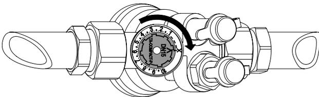
1. Drehen Sie das Handrad im Uhrzeigersinn auf die Stellung X.
