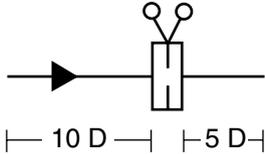
Die Messblende ist zwischen zwei Gegenflanschen zu installieren. Es ist sicherzustellen, dass die Gegenflansche parallel ausgerichtet sind und die Dichtungen dem Standard für die Flansche entsprechen. Vor dem Festziehen sicherstellen, dass die Messblende und die Dichtungen korrekt zentriert sind.
