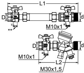
**Anschluss-Set TA-COMPACT-P, horizontales Set für Durchflussregelung, inkl. Passtück für Wärmehähler**
