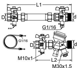
**Anschluss-Set TA-COMPACT-DP, horizontales Set für Differenzdruckregelung, inkl. Passtück für Wärmehähler**
