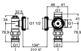
**Thermostatisches Mischventil für Flächenheizung**
