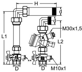
**Anschluss-Set TA-COMPACT-P, vertikales Set für Durchflussregelung, inkl. Passtück für Wärmehähler**
