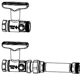
**Anschluss-Set 4 mit Globo Kugelhahn DN 20 einschl. Distanzstück für Wärmemengenzähler im Rücklauf**
