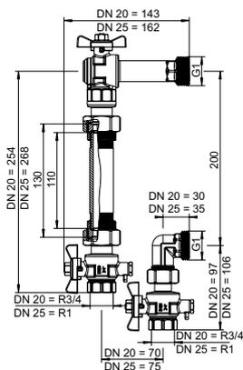
**Anschluss-Set in Eckform mit Kugelhähnen, einschließlich Distanzstück für Wärmemengenzähler im Rücklauf. Kugelhähne mit Anschluss M10x1 für die Tauchfühler des Wärmemengenzählers im Vor- und Rücklauf.**
