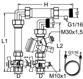
**Anschluss-Set TA-COMPACT-DP, vertikales Set für Differenzdruckregelung, inkl. Passtück für Wärmehähler**
