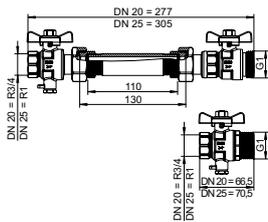
**Anschluss-Set in Durchgangsform mit Kugelhähnen, einschließlich Distanzstück für Wärmemengenzähler im Rücklauf. Kugelhähne mit Anschluss M10x1 für die Tauchfühler des Wärmemengenzählers im Vor- und Rücklauf.**
