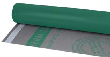
PP-Dampfbremse und Luftdichtheitsbahn für Dach-, Decken-, Wandkonstruktionen, Polypropylen-Vlies, Brandklasse E, s<sub>d</sub>-Wert 2 m, Temperaturbeständigkeit -30 °C bis +80 °C, Längsüberlappung beidseitig mit Acrylat-Klebeband (NSK)
