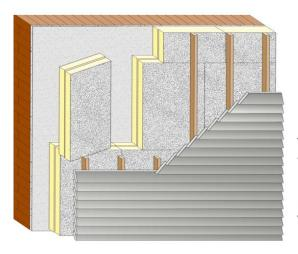
Die Dämmelemente LINITHERM PAL W werden zusammen mit der Unterkonstruktion an die Fassade geschraubt. So entsteht eine homogene Dämmschicht. Die beidseitige Alukaschierung verhindert das Eindringen von Feuchtigkeit. Der Dämmwert bleibt erhalten. Weitere Informationen zur Montage entnehmen Sie bitte den Hinweisen zur Verlegung.
