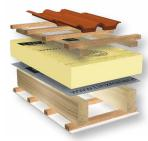
Altbausanierung oder Neubau LINITHERM PAL N+F Aufsparrendämmung mit raumseitiger Bekleidung.
