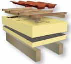
Altbausanierung oder Neubau LINITHERM PAL SIL T plus LINITHERM PAL N+F Aufsparrendämmung. Die sichtbaren Sparrenzwischenräume können verputzt gestrichen oder tapeziert werden.
