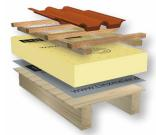
Altbausanierung oder Neubau LINITHERM PAL N+F Aufsparrendämmung mit sichtbaren Sparren und Holzschalung.
