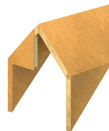
Satteldachgaube mit Giebelelement
