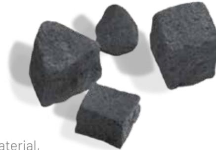
**GEOMATERIALS Schaumglas** ist ein hochwertiges Baumaterial, welches aus Altglas hergestellt wird. Seine Materialeigenschaften schaffen ein solides Fundament bei Bodenaufbauten. Eine weitere nützliche Eigenschaft ist die Drainagefunktion der Rollierung. Als leichter lastabtragender Schüttstoff überzeugt seine wärmedämmende Eigenschaft als Außendämmung gegen das Erdreich. Der einfache und wärmebrückenfreie Bodenaufbau ist mit **GEOMATERIALS Schaumglas** ein einfaches Unterfangen.
