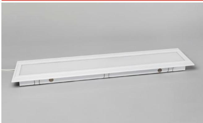
**Leuchtenkörper** LED-Universalleuchte (inkl. Befestigungssatz), Gehäuse weiß pulverbeschichtet, Lichtleitung über Opal-Kunstglasscheibe, Rahmen durch Riegelverschluss beidseitig abklappbar
